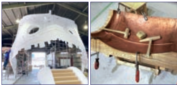
原寸大の発泡スチロール模型と脚部の成形の様子。 Full-scale polystyrene model and shaping of the legs.
