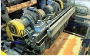
丸太から桂剥きされ3mmの薄板に加工 Peeling logs into thin veneers 3mm thick
