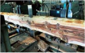
丸太から挽板への加工(スギ) Slicing logs into boards (Japanese cedar)
