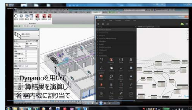
アルゴリズムを利用した設備設計の自動化 Automation of Mechanical System Design Using Algorithms
