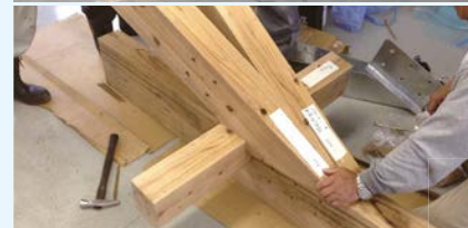
1. 林業研究所による強度試験の様子 | Strength Test Conducted by Forestry Research Institute 2. 森林組合における出荷式の様子 | The Shipment Ceremony at the Local Forestry Cooperative 3. モックアップによる納まり確認の様子 | Confirmation of Details with Mock-ups 4. 小径材の架構による普通教室 | Regular Classroom Structure Using Small Diameter Timber
