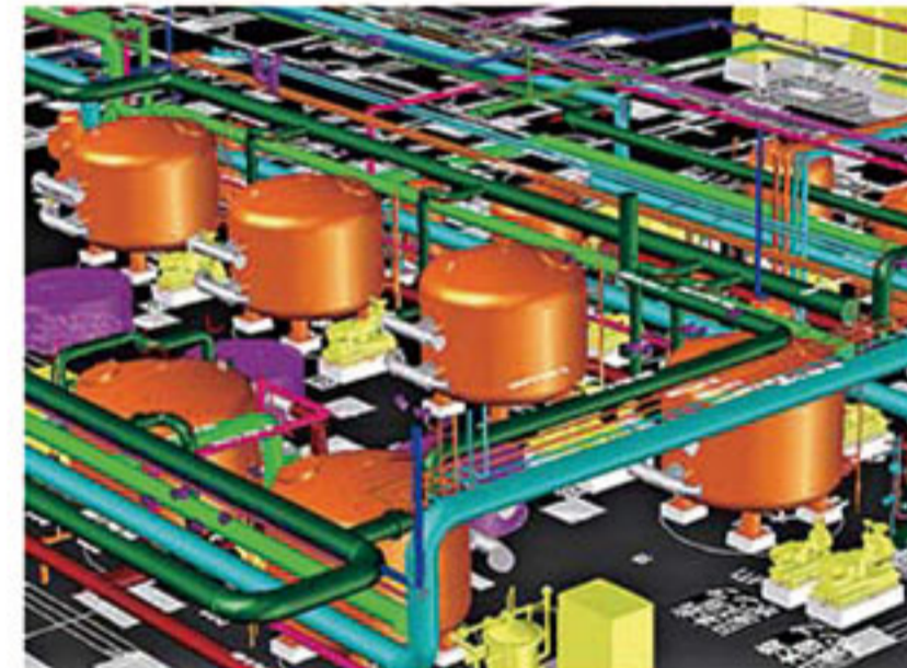
ろ過装置配置のBIMによるイメージ
