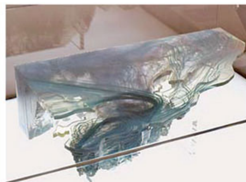
大水槽の3Dプリントによる水流模型
