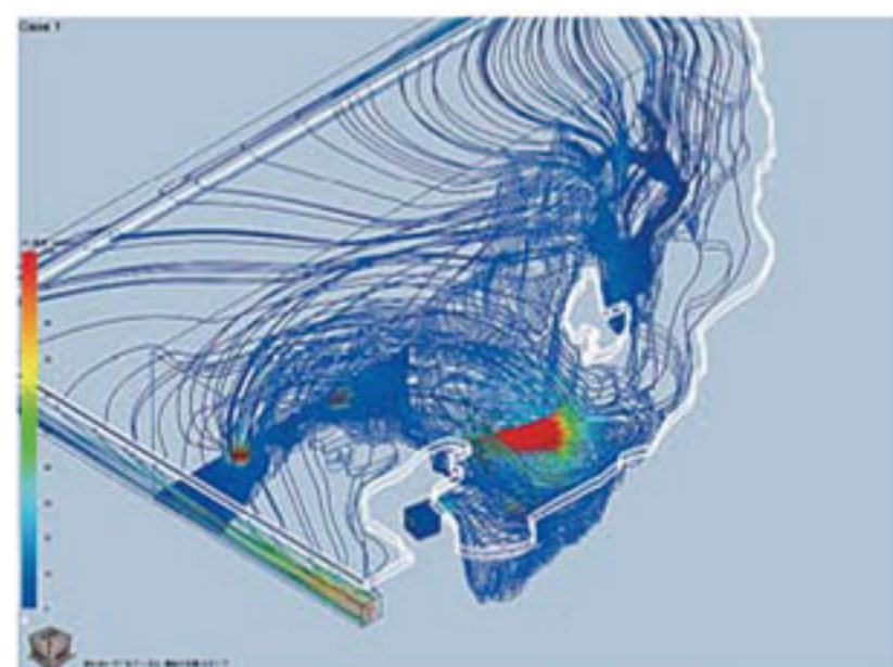
大水槽のCFD水流線図と流速
