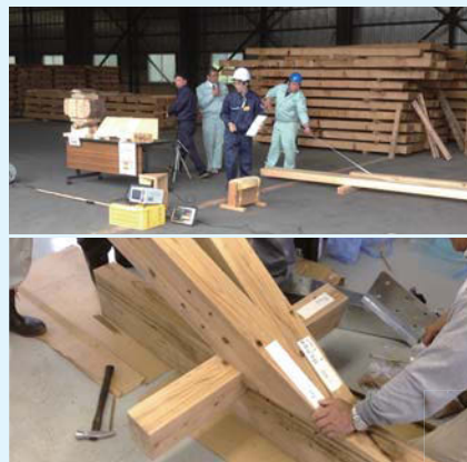
1. 林業研究所による強度試験の様子 | Strength Test Conducted by Forestry Research Institute 2. 森林組合における出荷の様子 | The Shipment Ceremony at the Local Forestry Cooperative 3. モックアップによる納まり確認の様子 | Confirmation of Details with Mock-ups 4. 小径材の架構による普通教室 | Regular Classroom Structure Using Small Diameter Timber
